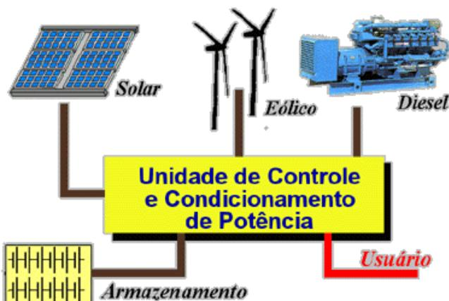
Figura 24 - Esquema de ligação de sistema híbrido.
